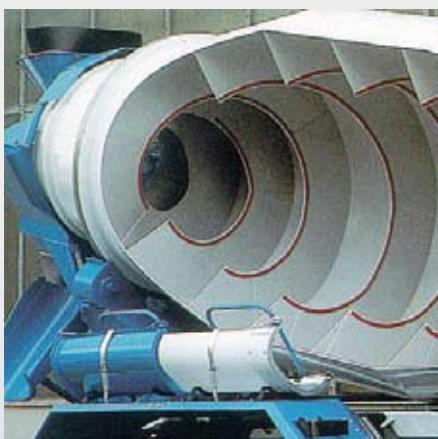
Acciaio speciale ed ulteriori fasce di usura aumentano la durata del tamburo
