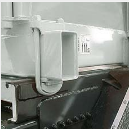
Fissaggi staffa per la trasmissione elastica dalla forza al telaio
