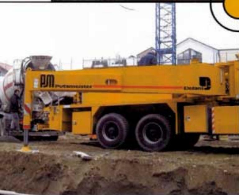
Per essere un allestimento da cantiere è completo e realizzato a regola d'arte. Non mancano accorgimenti astuti: il serbatoio supplementare dell'acqua ricavato nella parte cava di uno stabilizzatore posteriore, sistema attivo per il blocco della pompa in caso di contatti anomali sulla griglia della tramoggia, arresto delle pompe in casi di mancanza dell'acqua, impianto ad alta pressione per la pulizia del mezzo...
